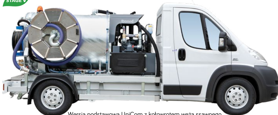
Wersja podstawowa UniCom z kotwrotnem węża ssawnego
