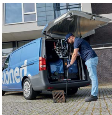
Obrotowy kołowrót z wężem o maksymalnej długości 120 m
